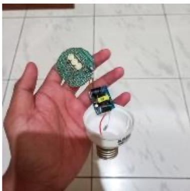
Gambar 7. Bagian dalam pada lampu pintar
