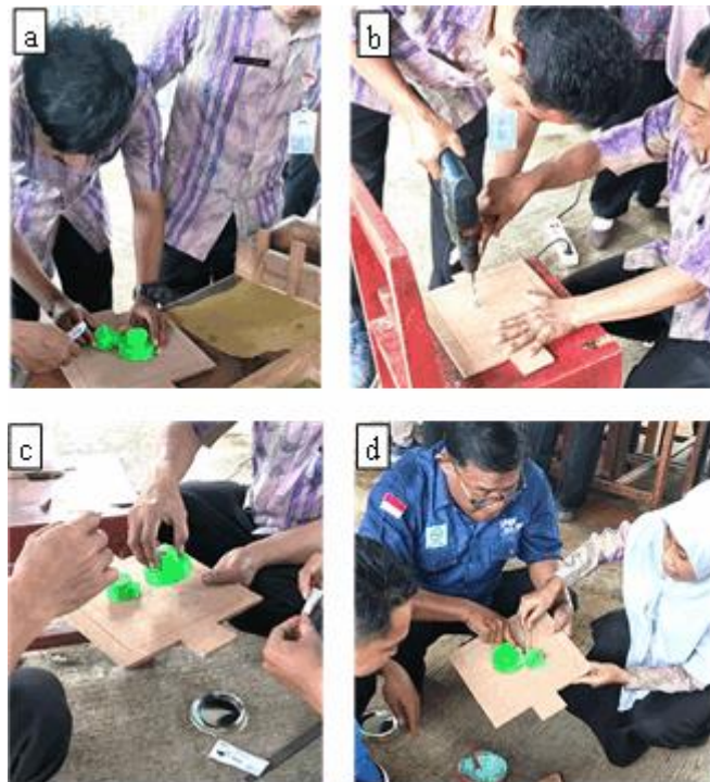
Gambar 10. (a) Memposisikan model pola; (b) Membuat lubang untuk pen pengepas; (c) Menempelkan pola; (d) Mendempul permukaan pola
