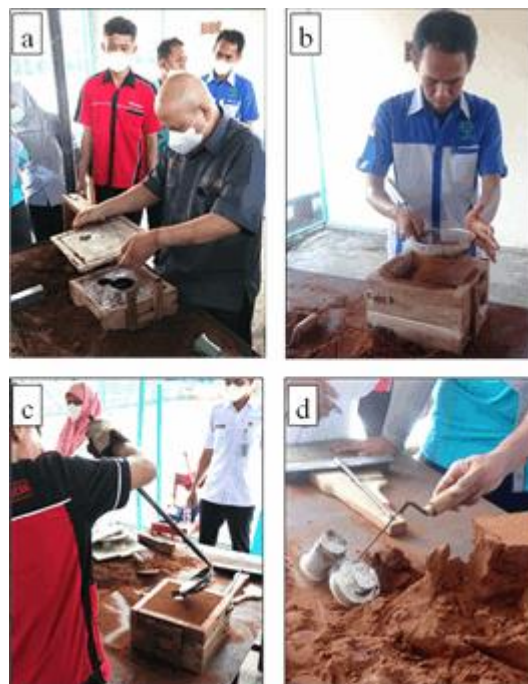
Gambar 11. (a) Peragaan membuat cetakan pasir; (b) Peserta membuat cetakan pasir; (c) Penuangan aluminium cair; (d) Produk coran
