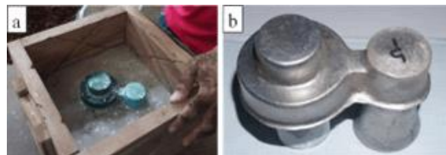
Gambar 7. (a) Uji coba model pola; (b) Produk hasil pengecoran
