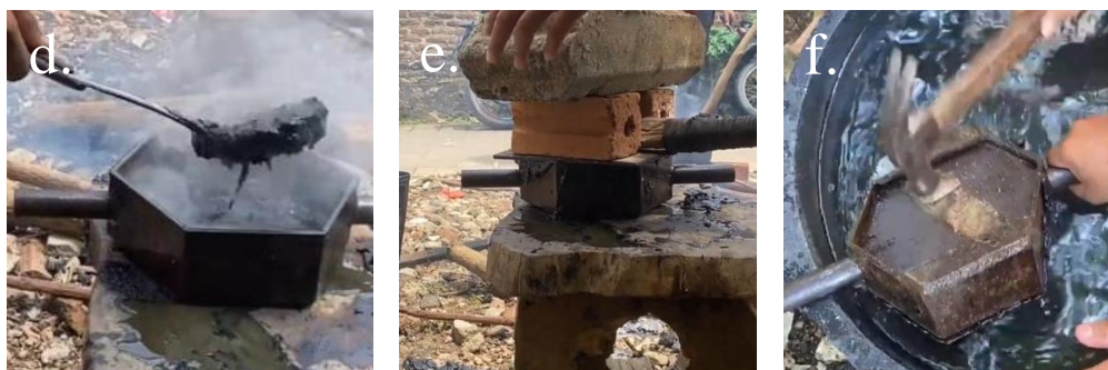
Gambar 2. (a) Pembakaran sampah plastik; (b) Pengolesan oli ke cetakan; (c) Pencetakan lelehan plastik; (d) Pengepressan lelehan; (e) Pendinginan lelehan plastik; (f) Pelepasan dari cetakan
